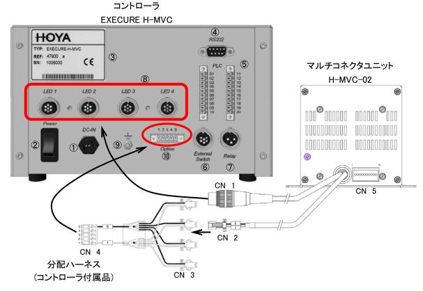
・H-MVC-02のコネクタ(CN1)をコントローラのLED1-LED4コネクタへ接続してください。
